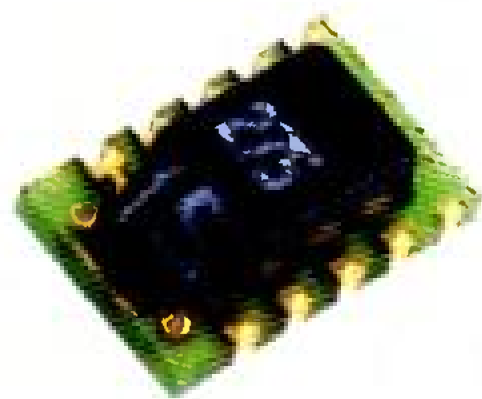
Senzor SHT15 od GME ( 7,4 \times 4,9 \text{ mm} )
